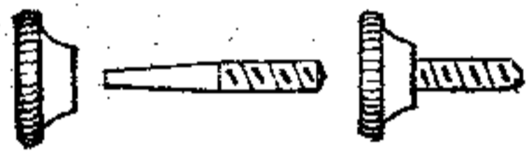
993. Заготовленіе установительнаго винтика.
